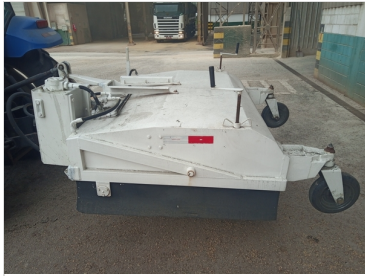
Troca da cerda concluída 8/5/23
